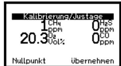
Jetzt kann das eingestellte Prüfgas über die Gaseinlassschraube (Pumpengerät) oder über den rechten Nippel des Prüfgasadapters (Diffusionsgerät) aufgegeben werden.
