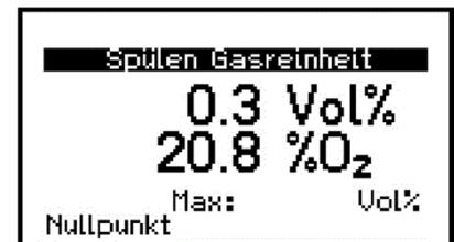
Der Messbereich liegt zwischen 0 und 100 Vol.-% Methan. Optional kann die Messung auch für Propan und Sauerstoff erfolgen, wenn das Gerät entsprechend kalibriert bzw. der O<sub>2</sub>-Sensor verbaut ist (**siehe Tabelle Übersicht Messbereiche 3.10**).
